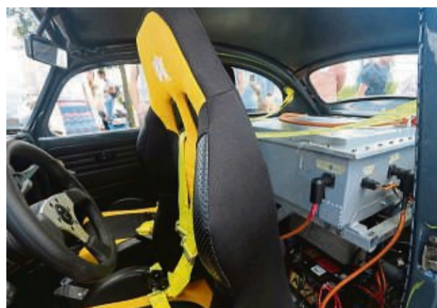
Energie von der Rückbank: Hinter den Vordersitzen und auch unter der vorderen Haube des Käfers sind die voluminösen Batterie-Pakete untergebracht.
