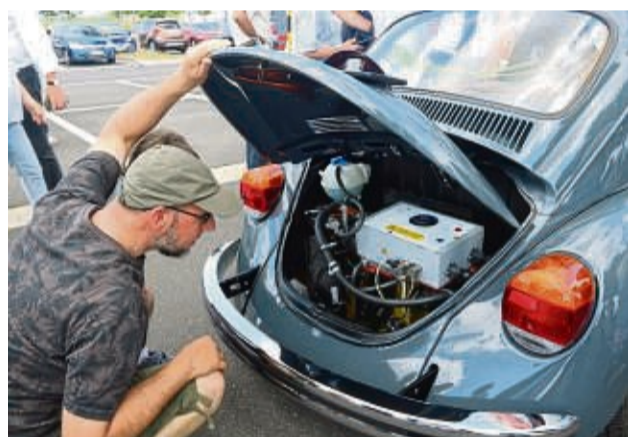
Elektrokraft statt Boxer-Sound: Im Heck des umgebauten Oldtimers arbeitet nun ein E-Motor, der umwelt-schonend rund 80 PS auf die Straße bringt.
